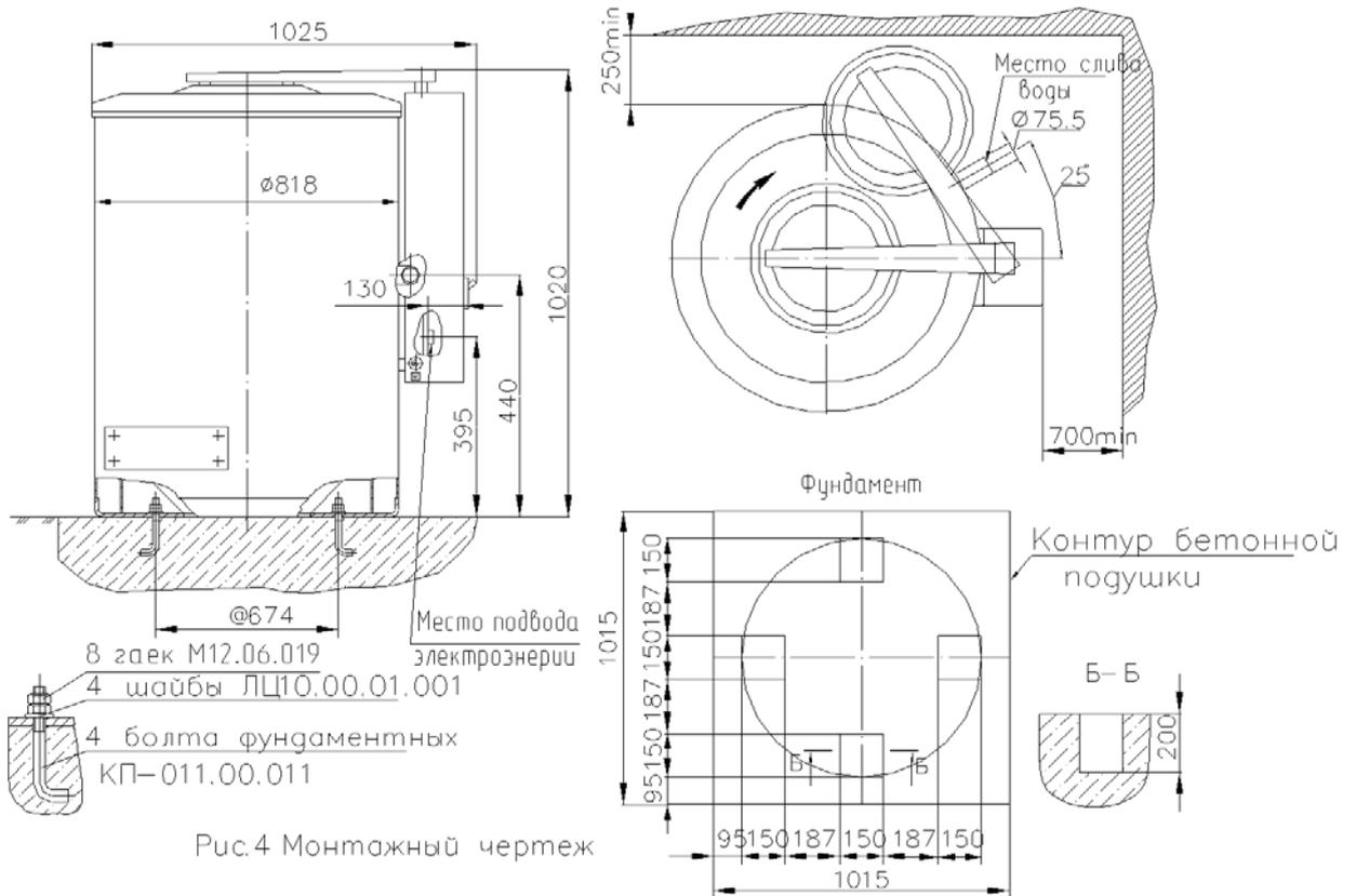
Рис.4 Монтажный чертеж
