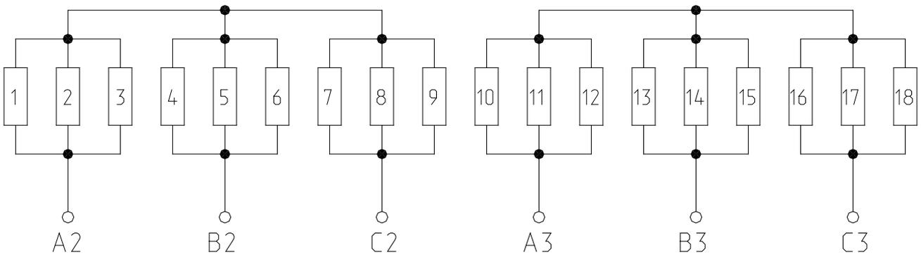
Схема соединений электронагревательных элементов E1, E2
