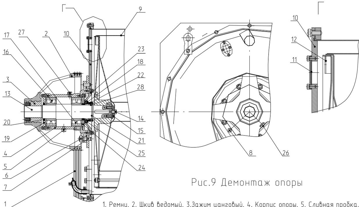
Рис.9 Демонтаж опоры
