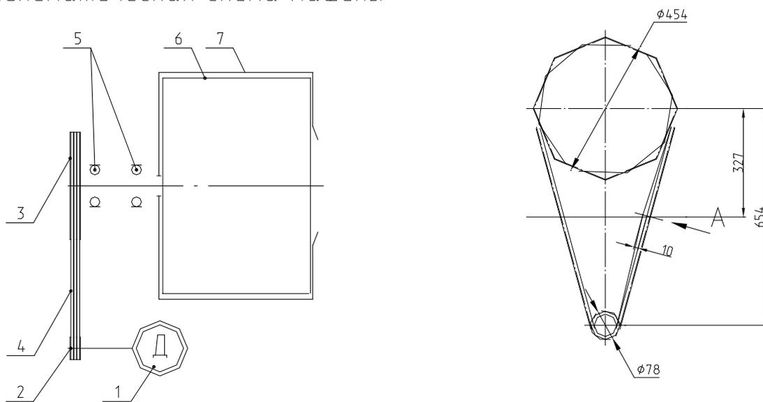
Прогиб ветви одного ремня должен быть 10мм при усилии  $Q=3 \pm 0,1$  кг для нового ремня и  $Q=2.18 \pm 0,1$  кг для приработанного ремня.
