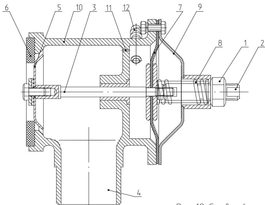
Рис.10 Сливной клапан
