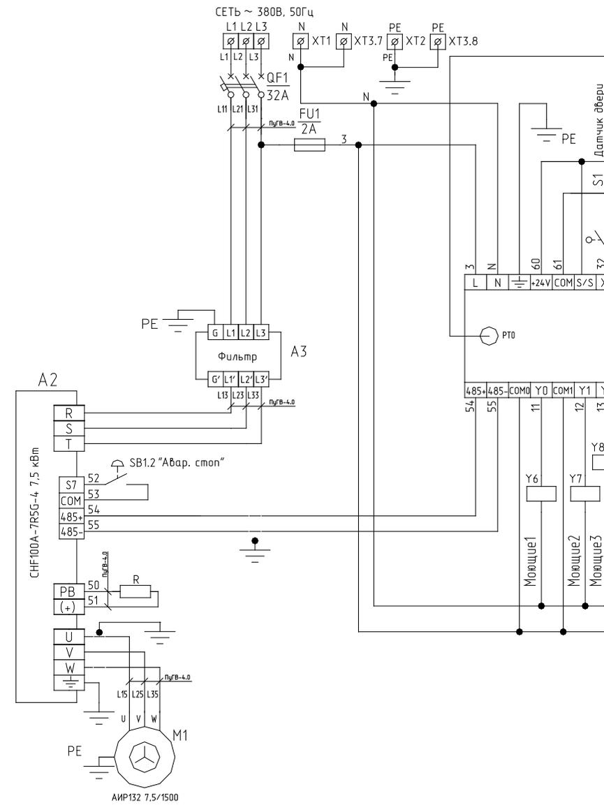
Рис. 6в. Схема электрическая принципиальная машины и контроллером INVT
