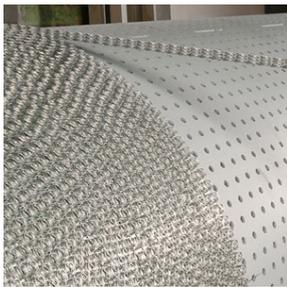
Гладильный каток ВГ-1630 имеет пружинную обмотку вала Springpress, которая позволяет равномерно прижимать белье к гладильному желобу по всей его поверхности, сглаживая возможные неровности. В том числе это актуально для тканей, имеющих утолщения на швах, пуговицы и т.д.
